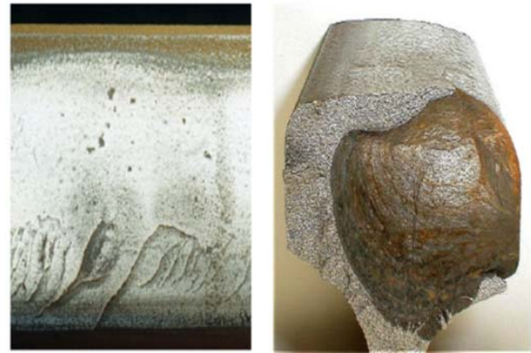
شکل (۴): شکست عرضی در سر ریل [۷]
