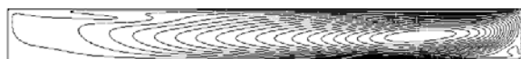
شکل (۱۴): کانتور لزجت مؤثر درهم برای Ri = 0.1 و مدل اغتشاش RNG k - \epsilon
