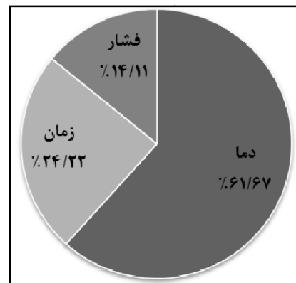
شکل ۷: نمودار درصد تاثیر هر یک از متغیرهای فرآیند پرس گرم بر چگالی نسبی دی بورید زیر کونیم.
