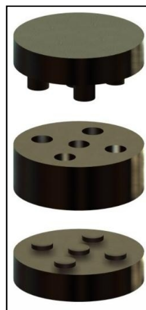
شکل ۱: طرح‌واره قالب گرافیتی برای پرس گرم نمونه‌ها.
