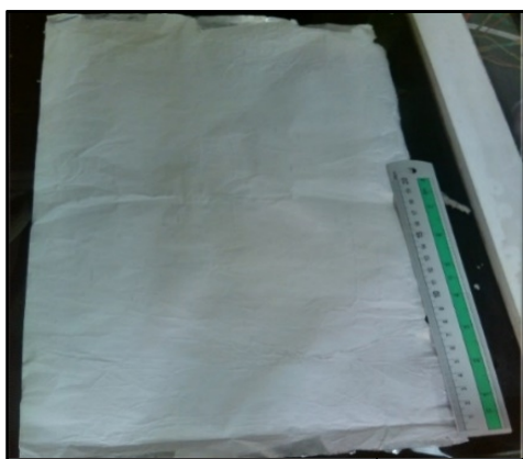
شکل ۲: نانوالیاف PVDF تهیه شده از روش الکتروریسی.
