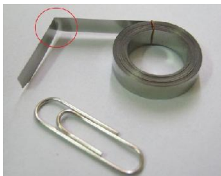
شکل ۴: فویل انجماد سریع یافته تولید شده به روش ریخته‌ریسی که به شکل حلقوی پیچیده شده است.
