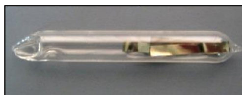
شکل ۱۱: نمونه کپسول شده تحت خلا 10^{-5} mbar.
