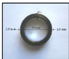
شکل ۳: طرح شمایی سیستم عملیات حرارتی مورد استفاده و تصویر فویل آمورف پیچیده شده برای عملیات حرارتی و پوشش دهی.
