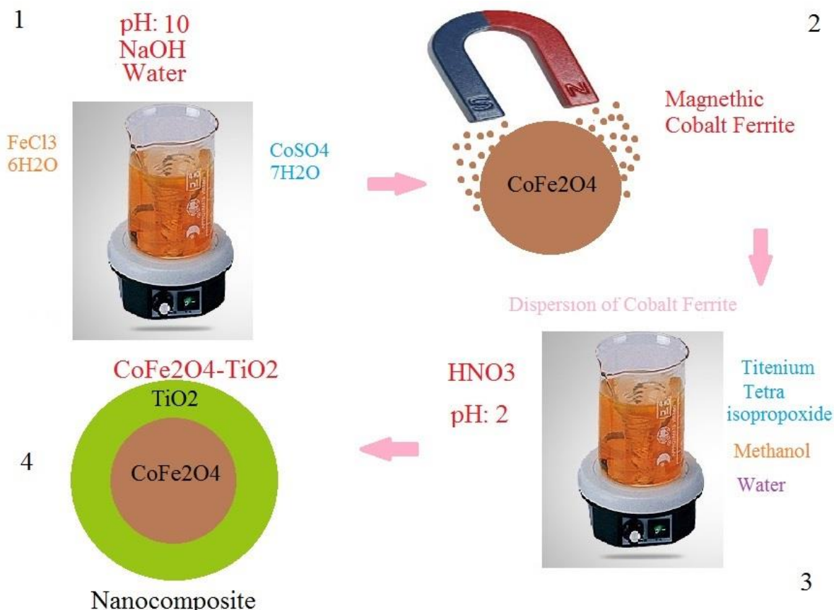
شکل ۱: شمایی از تهیه نانوذرات فریت کبالت و ساخت نانوکامپوزیت های \text{CoFe}_2\text{O}_4\text{-TiO}_2 .
