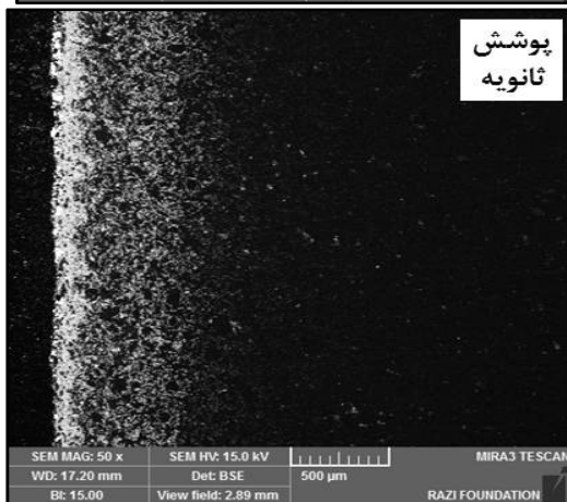
شکل ۶: SEM مقطع پوشش‌ها پس از اکسیداسیون به مدت ۱۰ h.
