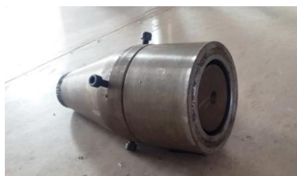
شکل ۲: قالب اکسترودر طراحی شده برای جایگذاری الیاف شیشه در میان بدنه لوله.
