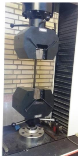
شکل ۳: آزمایش کشش محوری توسط دستگاه SANTAM 400.
