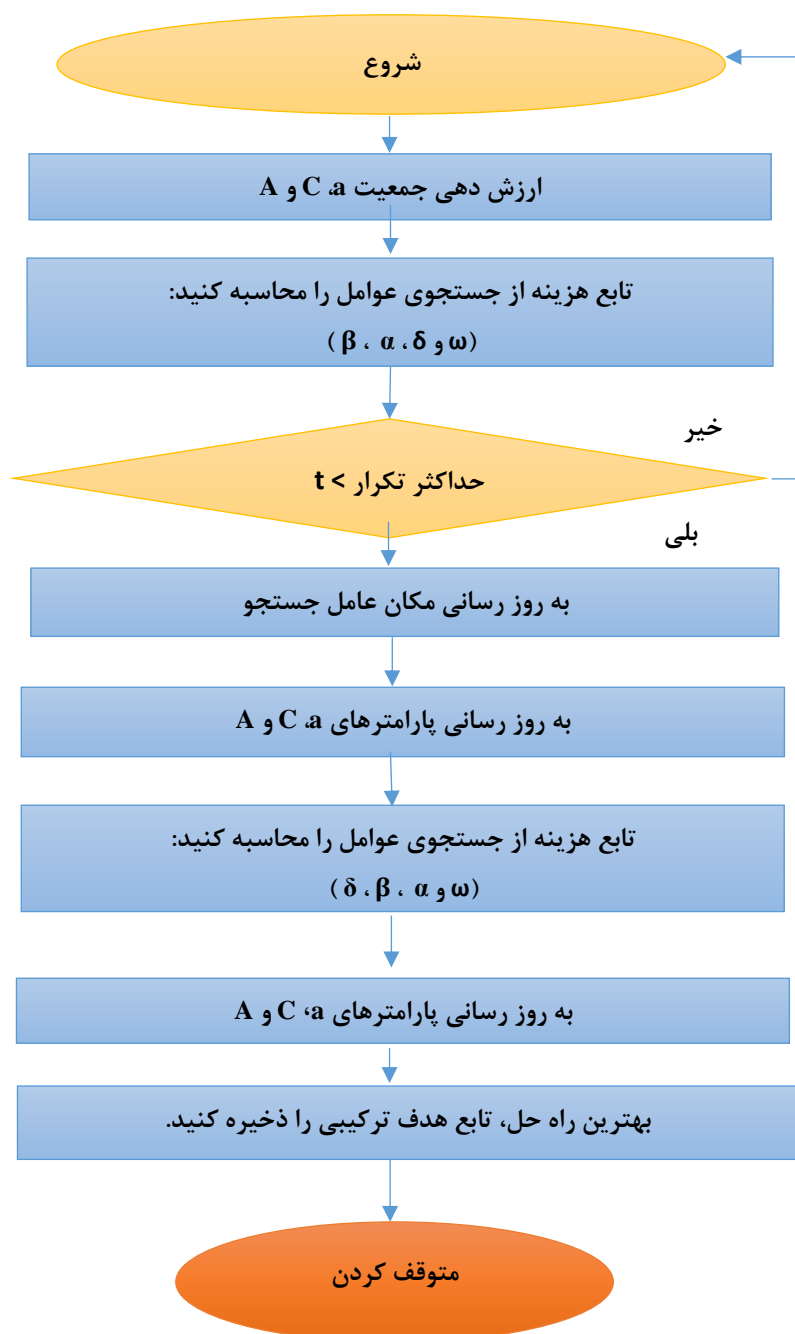
شکل ۲: نمودار گردش الگوریتم گرگ خاکستری Figure2. Flow diagram of the gray wolf algorithm
