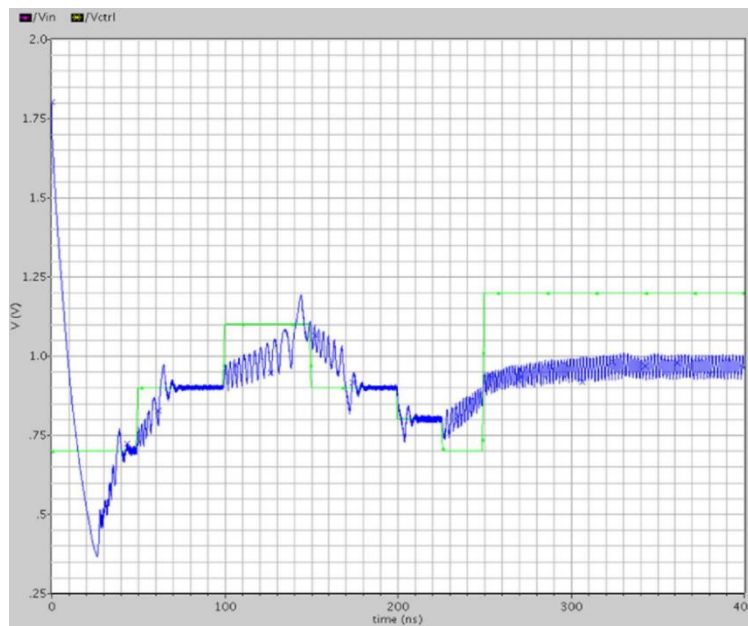
شکل ۱۴: اثر ورودی پله با شیب‌های متفاوت بر روی عملکرد حلقه قفل فاز شامل آشکارساز فاز XOR Figure 14. Effect of step input with different slopes on PLL with XOR phase detector performance
