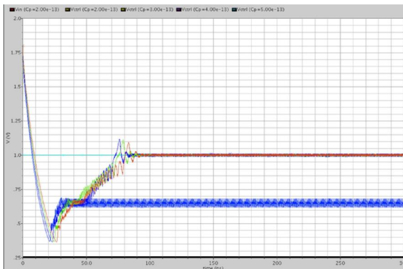
شکل ۱۱: اثر مقادیر خازن‌های کوچک بر روی عملکرد حلقه قفل فاز شامل آشکارساز فاز XOR با v_{in}=1V Figure 11. Effect of small capacitors on PLL with XOR phase detector performance for v_{in}=1V
