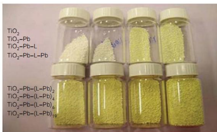
شکل ۱۰- لایه های سرب (۱۹ لایه) در پیرامون گهرمایه دی اکسید تیتانیوم Fig. 10. Layering of lead (19 layers) on a titanium oxide (TiO) substrate.
