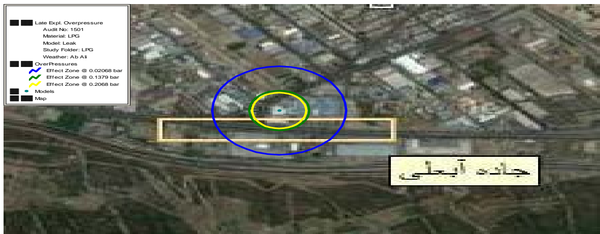
شکل ۲- نشت گاز و سپس انفجار ناشی از نشت (نگارنده ۱۳۹۰)
