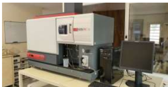
شکل ۱- دستگاه اسپکتروفتومتر مدل mini 1240 (سمت راست) و اسپکترومتر نشر اتمی پلاسما (سمت چپ)
