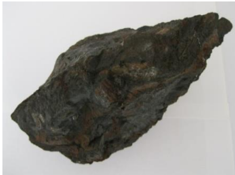
شکل ۳- نمونه سنگ آهن با ترکیب اصلی هماتیت
