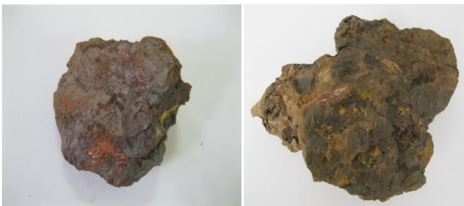
شکل ۴- نمونه سنگ آهن با ترکیب اصلی گوتیت و کانی‌های فرعی هماتیت و لیمونیت
