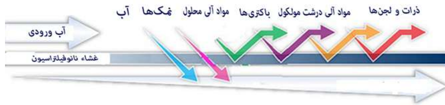
شکل ۵ - میزان تاثیر نانو غشا را بر روی ذرات محلول غیر محلول در آب را نشان میدهد.
