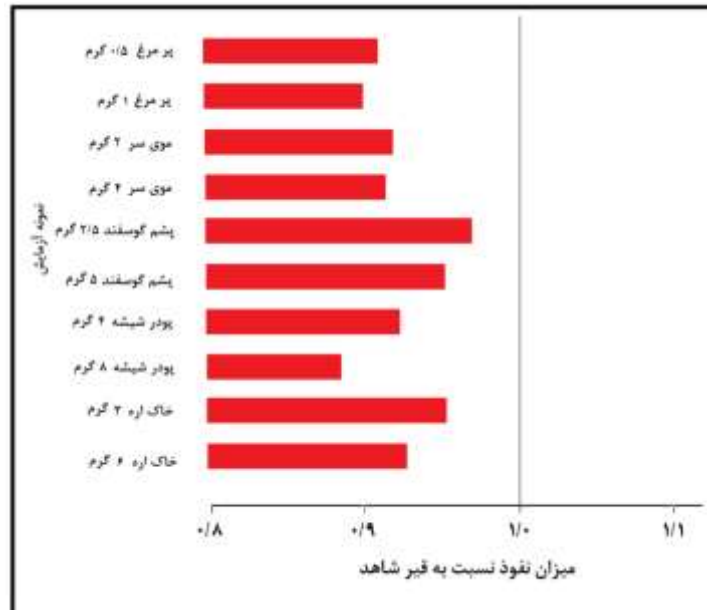
شکل ۱۱- نتایج آزمایش قابلیت نفوذ در کامپوزیت قیر
