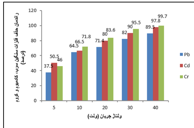
نمودار ۵- بررسی اثر ولتاژ جریان بر راندمان حذف فلزات سنگین سرب، کادمیوم و کروم
