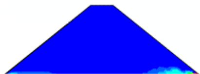
شکل ۷- ترک کششی ناشی از زلزله Kocaeli با PGA = 0.1g
