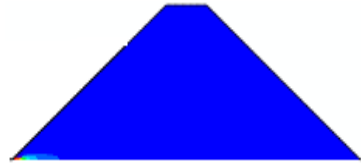
شکل ۱۲- ترک کششی ناشی از زلزله Loma Perita با PGA=0.3g
