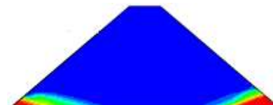
شکل ۵- ترک کششی ناشی از زلزله ی Duzci با PGA= 0.6g
