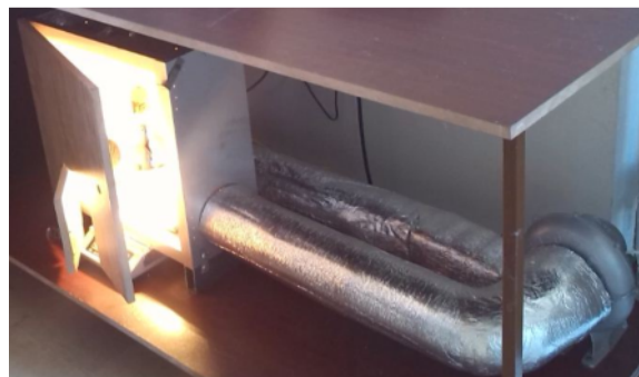
شکل ۱- خشک‌کن مادون قرمز- هوای داغ مورد استفاده در این تحقیق
