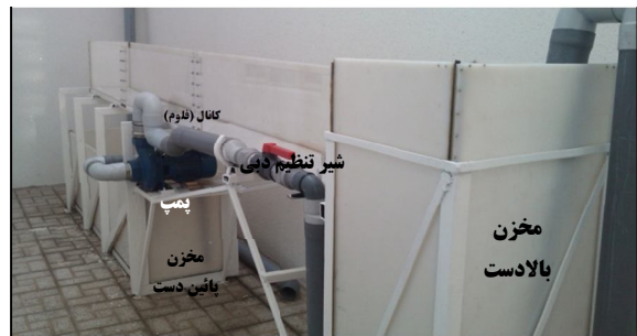
شکل ۲. مدل فیزیکی ساخته شده در این تحقیق
