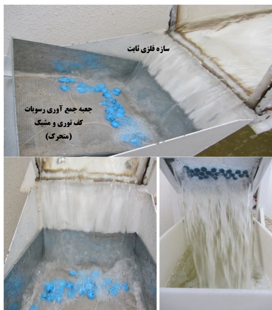
شکل ۴. سیستم جمع‌آوری رسوبات خارج شده از تله در انتهای کانال
