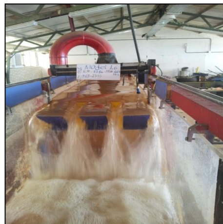
شکل ۳. سیستم تغذیه و گردش آب در آزمایشگاه
