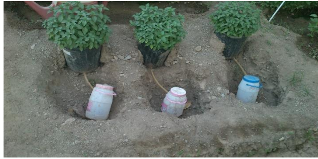
شکل ۱. نمایی از روش میکرو لایسیمیترهای پیشنهادی در حال اندازه گیری در سایت پژوهشی دوشان تپه
