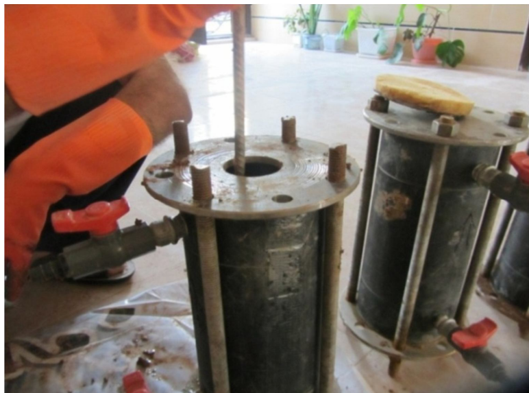
شکل ۴. متراکم کردن خاک در داخل سلول آبتوی
