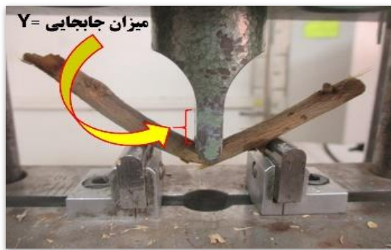
شکل ۲. آزمون خمش سه‌نقطه‌ای
