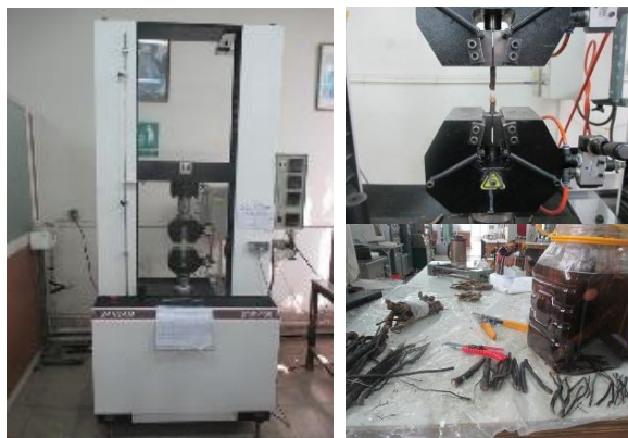
شکل ۳. آزمون مقاومت کششی ریشه با استفاده از دستگاه STM-150
