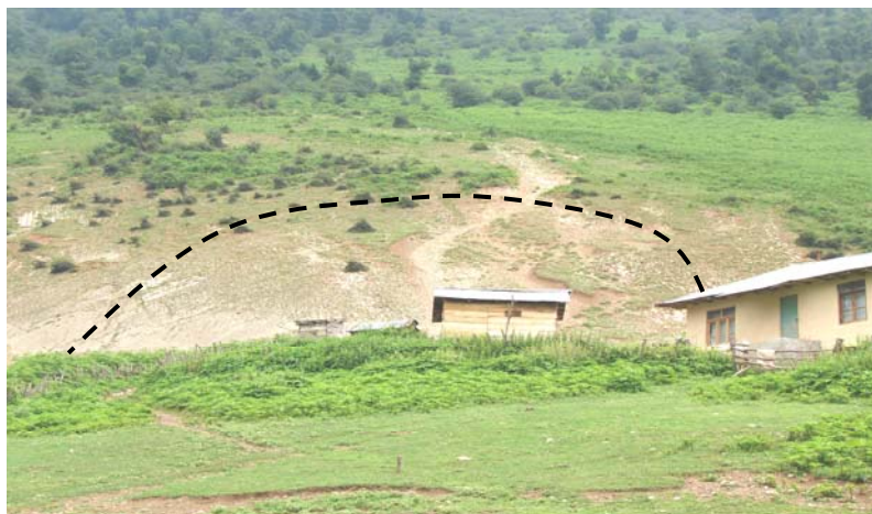
شکل شماره ۱۱- عکس نمایی از لغزش در پشت دهرداری ارده (شمال حوضه)
