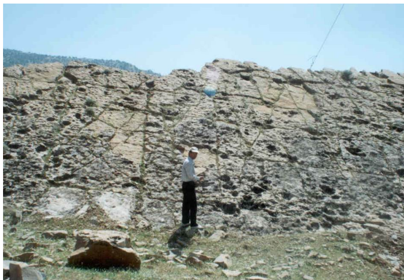
شکل ۱۳ - نمایی از شکستگی‌های غالب موجود در منطقه از یال شمالی تاقدیس پایده
