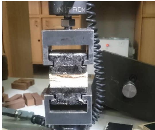
شکل ۴. تست چسبندگی داخلی نمونه‌های تخته‌خرده‌چوب
