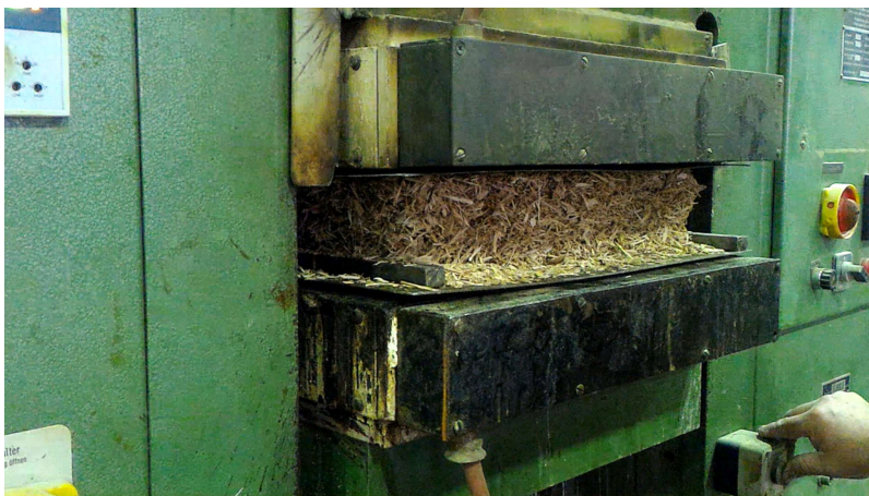
شکل ۲. ساخت تخته خرده چوب از چوب درخت صنوبر هیبریدی (پده-کبوده) رقم «مفید»
