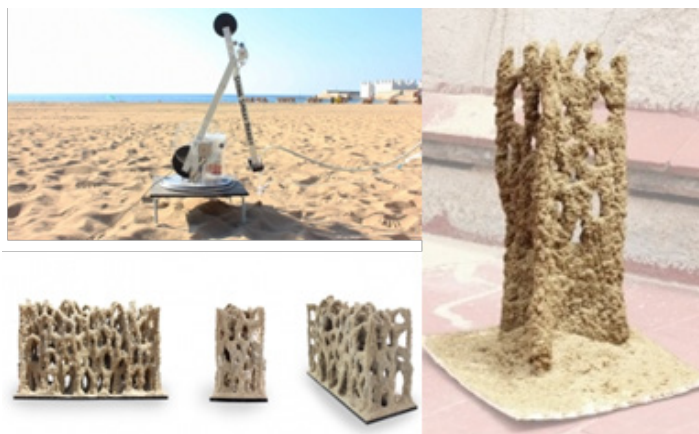
شکل ۴. استفاده از پرینترهای سه بعدی و مصالح اولیه موجود در طبیعت (Source: Philippawagner, 2017)
