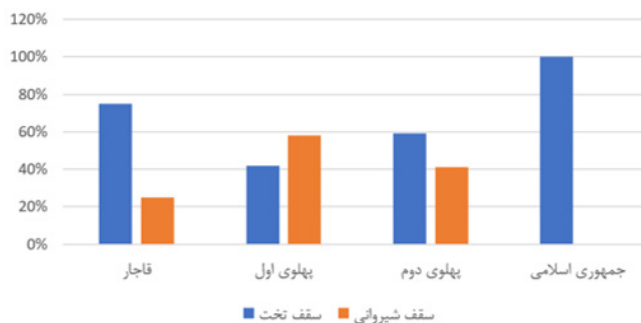
شکل ۴. مقایسه دوره‌ای نوع سقف به‌کاررفته در ایستگاه‌های راه‌آهن خط شمال غرب ایران Figure 4. Periodical comparison of the ceiling types in the railway stations of the northwestern Iran
