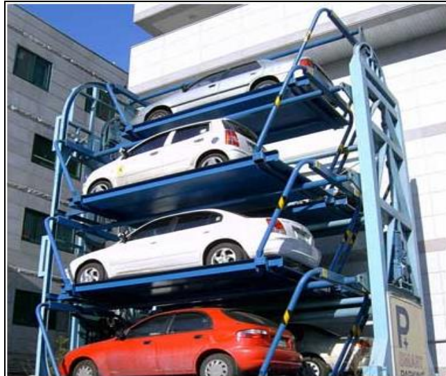
شکل ۵: نمونه ای از پارکینگ مکانیزه روتاری
