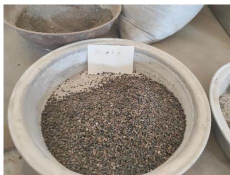
شکل ۱- سبکدانه پرلیت مصرفی در این تحقیق
