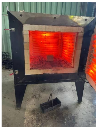
شکل ۷- نمونه قرار گرفته در کوره جهت اعمال حرارت بالا
