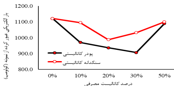
شکل ۹- مقایسه بار الکتریکی عبور کرده از نمونه‌ها در آزمایش RCPT
