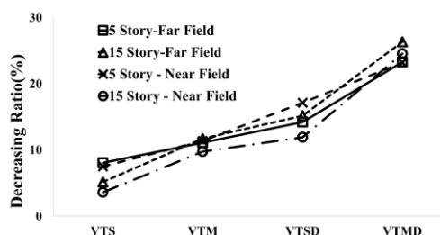
شکل ۱۲- نسبت میانگین کاهش بیشینه جابجایی زیرسیستم جرمی نسبت به VMI
