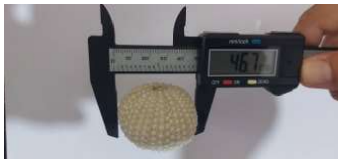
شکل ۲- نحوه اندازه‌گیری قطر توتیا با استفاده از کولیس دیجیتالی
