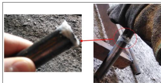
شکل ۲: روش مالیدن نانوفیلر بر سطح اتصال.
