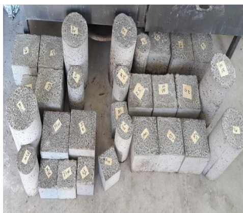
شکل ۱- نمونه‌ها قبل از قرار گرفتن در محلول سولفات
