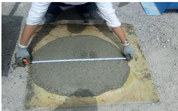
شکل ۴ - آزمایش جریان اسلامپ
