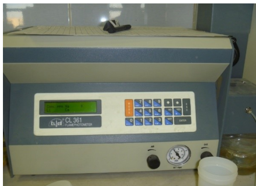
شکل ۳: دستگاه فلیم فتومتر در حال سنجش پتاسیم
