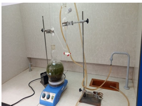
شکل ۲: سیستم کلونجر در حال استحصال اسانس
