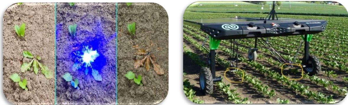
شکل ۳. ربات مجهز به هوش مصنوعی در حال وجین علف‌های هرز (راست) و کاربرد لیزر پالسی با ربات هوشمند در کنترل علف هرز (چپ)
