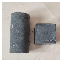
ج- مقایسه بصری ابعاد نمونه‌های مکعبی و استوانه‌ای
