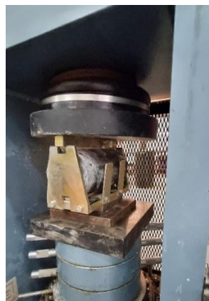
شکل ۵- نحوه ی بارگذاری نمونه استوانه ای (کشش برزبلی)
