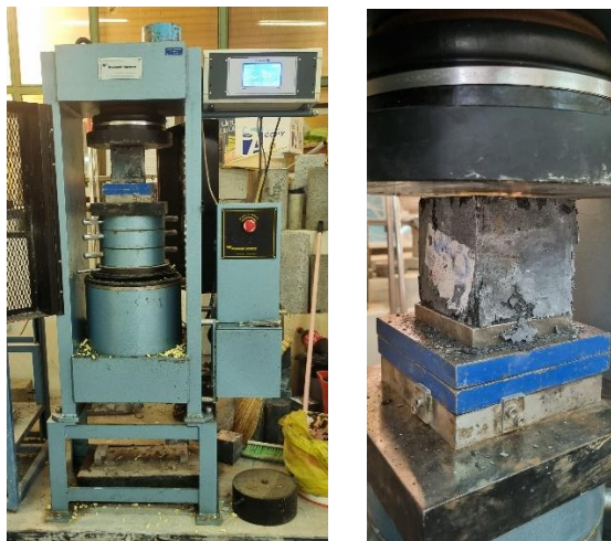
الف- نمونه مکعبی تحت بار فشاری ب- نمای دور نمونه تحت بارگذاری
