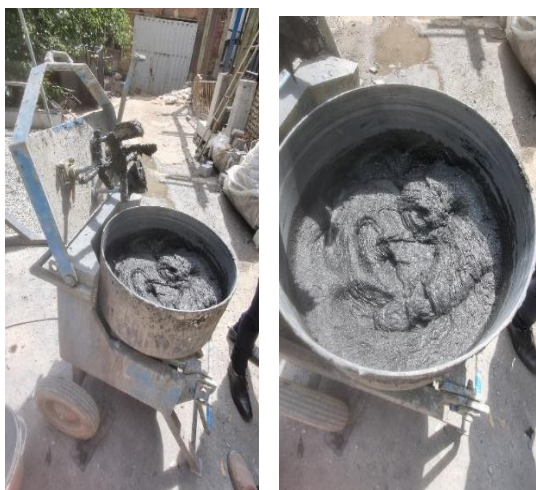
شکل ۲- میکسر جهت اختلاط مناسب بتن فوق توانمند
