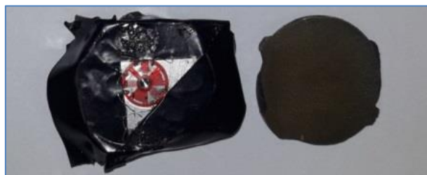
شکل ۶: تصویر نمونه قبل و بعد از آزمون کرنش سنجی سوراخ
