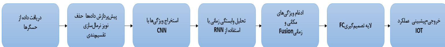
شکل ۱-فلوچارت مراحل پیش پردازش و اجرای الگوریتم CNN-RNN روی دستگاه های IoT
