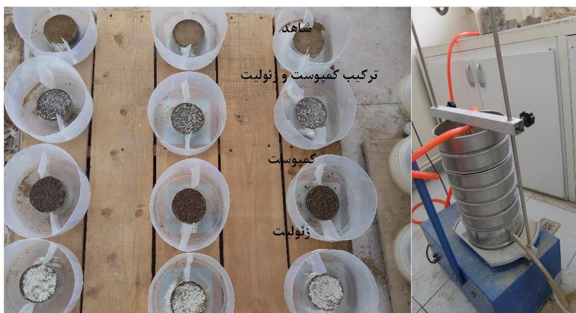
شکل ۲. نمونه‌های شاهد، کمپوست، زئولیت و ترکیب آن‌ها در شرایط آزمایشگاهی (سمت راست) و الک تر (سمت چپ) جهت اندازه‌گیری پایداری خاکدانه‌ها
