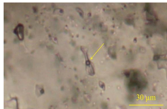
شکل (۵): باریک شدگی (necking down) در میانبرهای سیال دو فازی غنی از مایع (L+V) در نمونه‌های باریت کانسار آب ترش.
