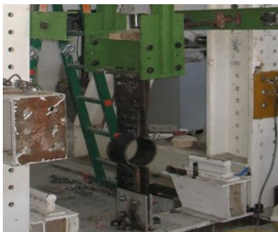
شکل ۱۲- بررسی نیم حلقه‌های فولادی در اثر بارهای رفت و برگشتی [۲۰]
