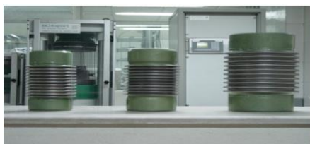
شکل ۲۰- نمونه‌های مورد آزمایش لوله‌های جدار نازک آکاردئونی [۲۷]
