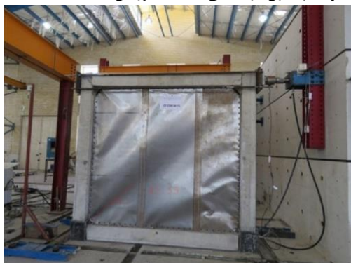
شکل ۷- تشکیل میدان کششی قطری در نمونه ورق سیاه
