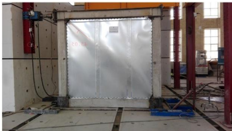
شکل ۹- تشکیل میدان کشش قطری نمونه ورق گالوانیزه
