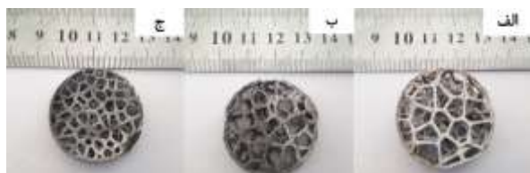
شکل (۳). نمونه‌های متخلخل آلومینیومی: الف) نمونه 5\text{ ppi} ، ب) نمونه 7\text{ ppi} ، ج) نمونه 10\text{ ppi} .
