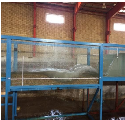
شکل ۹- نحوه‌ی برخورد افشانه با مصالح و ایجاد حفره‌ی آبستگی
