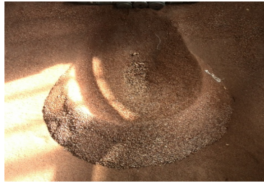
شکل ۳- الگوی آبشستگی ناشی از فشانه مرکب در ۶ cm
