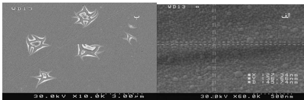
شکل ۳- تصاویر FE-SEM مربوط به نمونه شماره (۱) پوشش \text{TiO}_2 خالص در دمای 400 درجه سانتی‌گراد، (الف) پوشش با بزرگنمایی 10000 برابر، (ب) پوشش با بزرگنمایی 60000 برابر.
