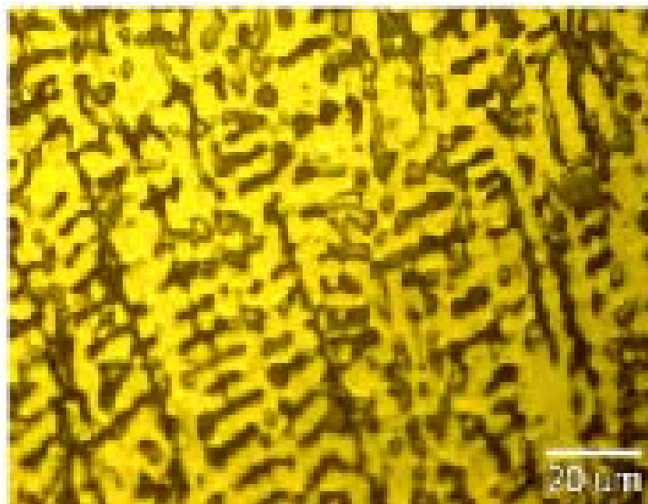
شکل ۴- ریزساختار فلز جوش ۳۰۹L مربوط به پاس نخست.
